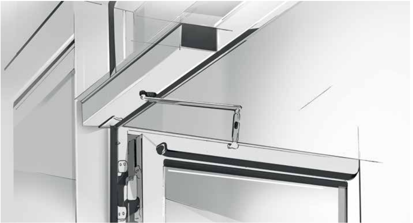
Beispielhafter elektromotorischer Antrieb mit Sensorleisten.
