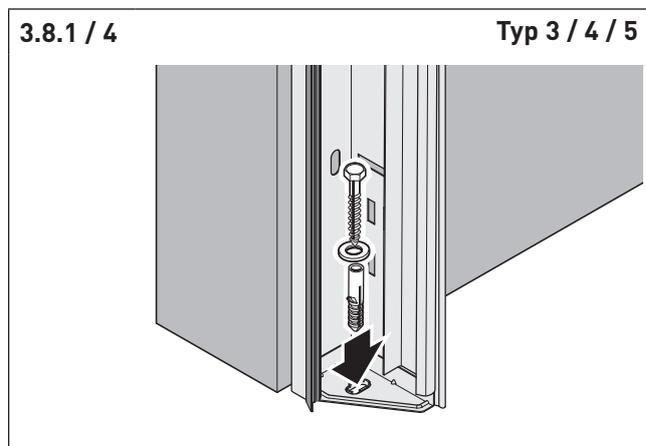
⇒ Verschrauben Sie die Zarge mit dem Boden.
