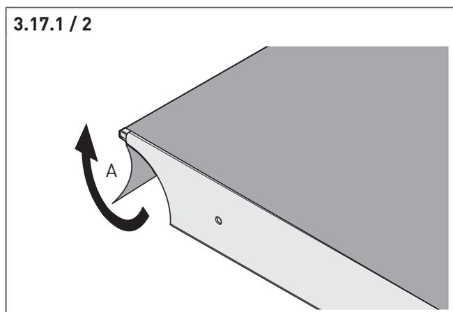
Alle Sektionaltorpaneele sind mit einer Schutzfolie versehen. Diese kann je nach Paneelhöhe im Bereich der Rundung (A) liegen.
