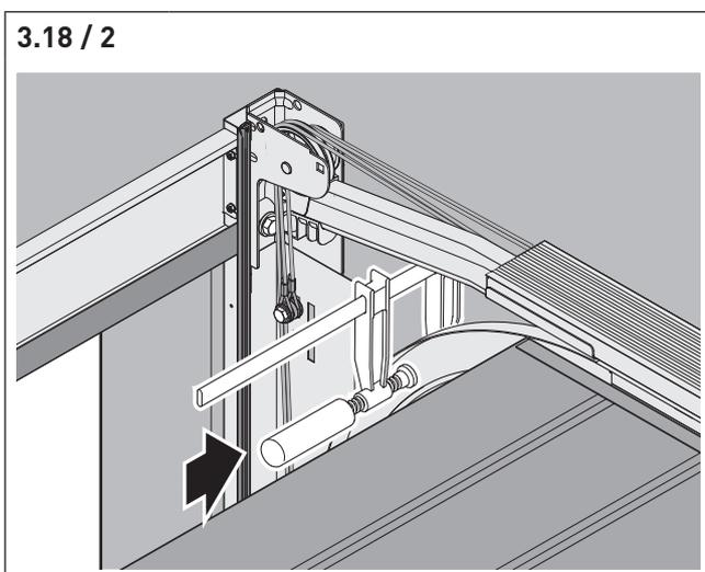
⇒ Sichern Sie das geöffnete Tor rechts und links mit Schraubzwingen in der Laufschiene.
