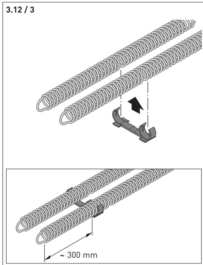
⇒ Stecken Sie ein zweites Kunststoff Gleitstück von unten an das andere Ende der Feder.
