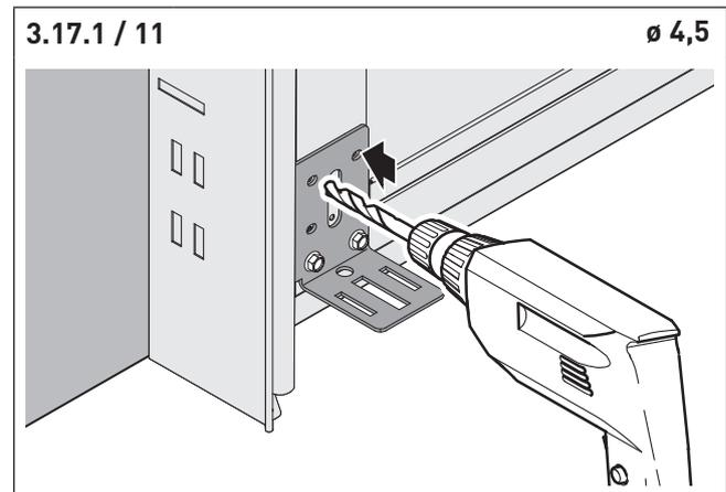
⇒ Bohren Sie gegebenenfalls die fehlenden Löcher für die Verschraubung.
