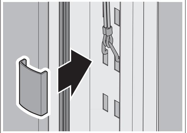
⇒ Montieren Sie die Abdeckung des Seilbügels.
