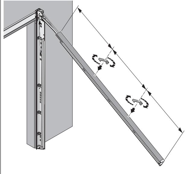
⇒ Sichern Sie die Abdeckung mit den Federkanalbügeln.
