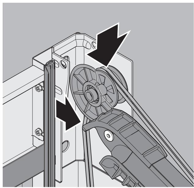
⇒ Führen Sie das Seil **über** den Laufbogen und die Stützrolle in die Zargenkonsole ein.
