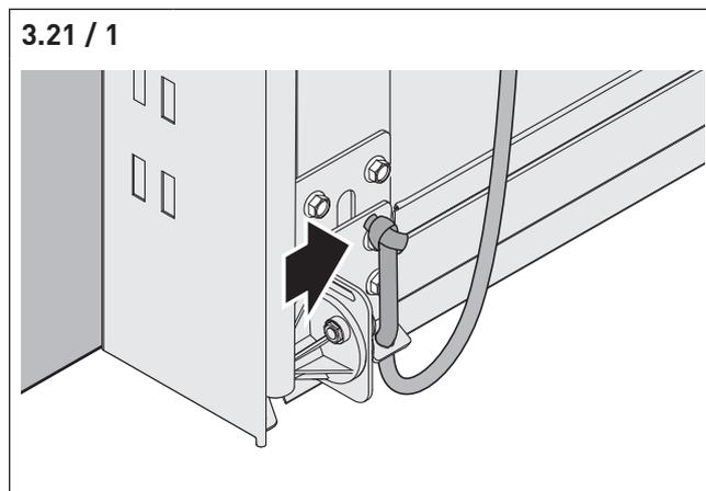
⇒ Stecken Sie das Zugseil von unten durch die Lasche der Bodenkonsole und verknoten Sie das Seilende.
