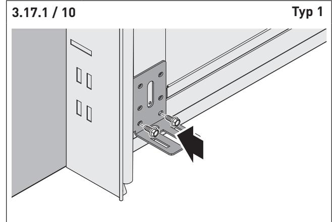
⇒ Verschrauben Sie die unteren beiden Schrauben der Bodenkonsole mit der unteren Torsektion.
