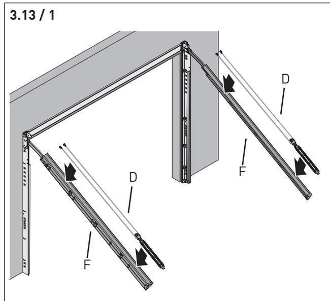
Die Federpakete (D) sind nicht gleich. Die Federpakete rechts und links müssen der entsprechenden Torseite so zugeordnet werden, dass der Seilbügel (E) zur Toraußenseite zeigt.
