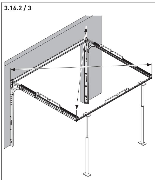
Die Laufschienen sind dann korrekt ausgerichtet, wenn beide Diagonalen gleich lang sind. Um ein genaues Messergebnis zu erzielen, müssen für jede Diagonale die gleichen Messpunkte verwendet werden.
