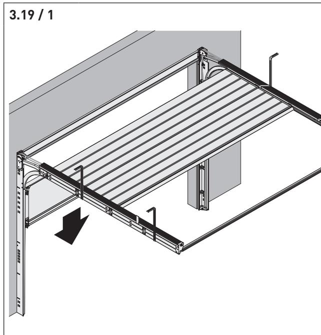
⇒ Schließen Sie das Tor und prüfen Sie die Federspannung.
