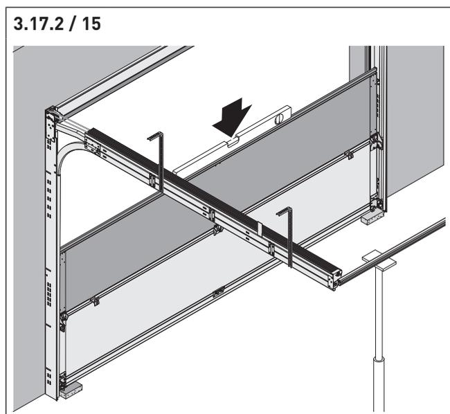
⇒ Prüfen Sie, ob das Tor waagrecht ausgerichtet ist. Um das Tor waagrecht auszurichten, können Sie die Höhe der Holzunterfütterung anpassen (vgl. Abb. „3.17.1 / 14“ und „3.17.1 / 16“).
