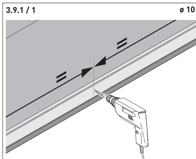
Bis zu einer Torbreite von 3 m reicht eine Verschraubung in der Sturzblende aus.
