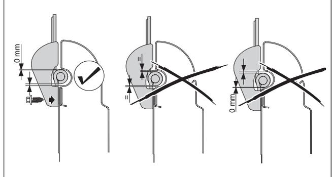
Alle Mittelscharniere und Seitenscharniere müssen so verschraubt werden, dass das Scharnier an die obere Sickenkante stößt.
