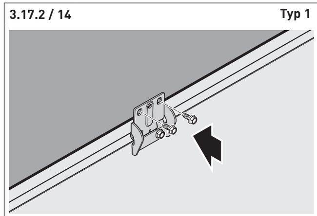
⇒ Schrauben Sie die Mittelscharniere an die obere Sektion.
