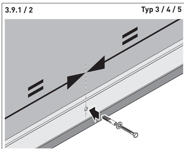
⇒ Verschrauben Sie die Sturzblende mit der Mauer.
