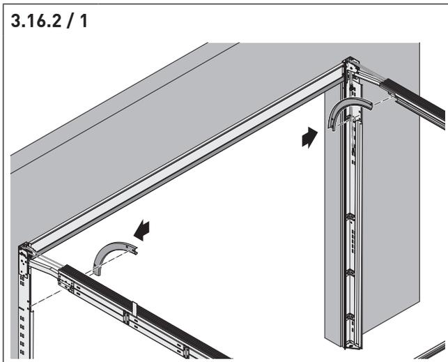
⇒ Setzen Sie den Laufbogen rechts und links zwischen die senkrechten und die waagerechten Laufschienen ein.
