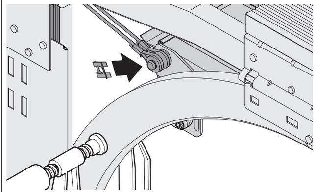
⇒ Sichern Sie die Seilaufnahme-Buchse mit der SL-Sicherung.
