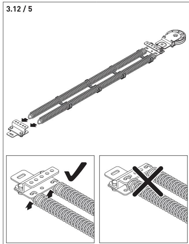
⇒ Montieren Sie den Federhalter an die Federn.
