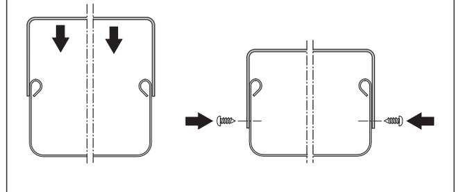
⇒ Schrauben Sie die Abdeckung an den dafür vorgesehenen Löchern auf den Federkanal.
