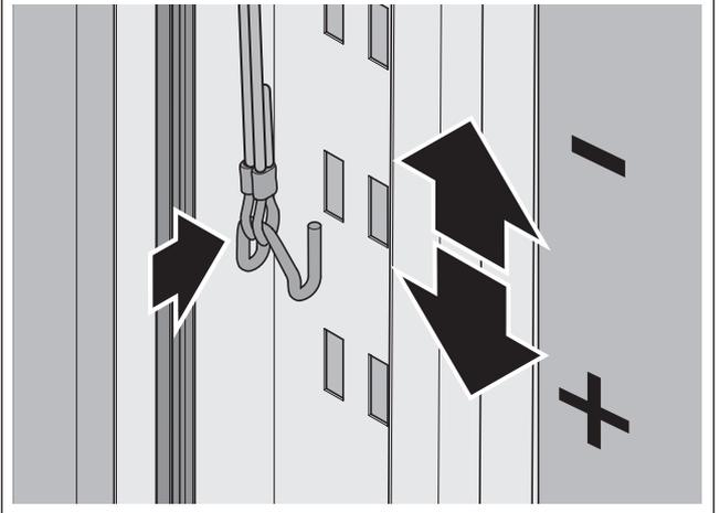
⇒ Stellen Sie die korrekte Federspannung ein, indem Sie den Seilbügel in eine andere Lochung einhängen.
