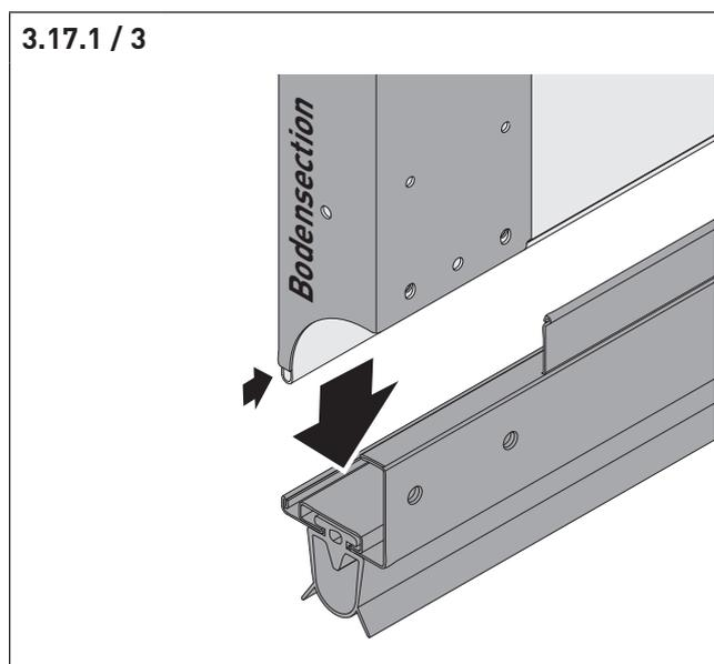
Sie erkennen die untere Torsektion an dem seitlichen Aufkleber mit der Aufschrift „Bodensektion“ und an den gekürzten Endkappen.
