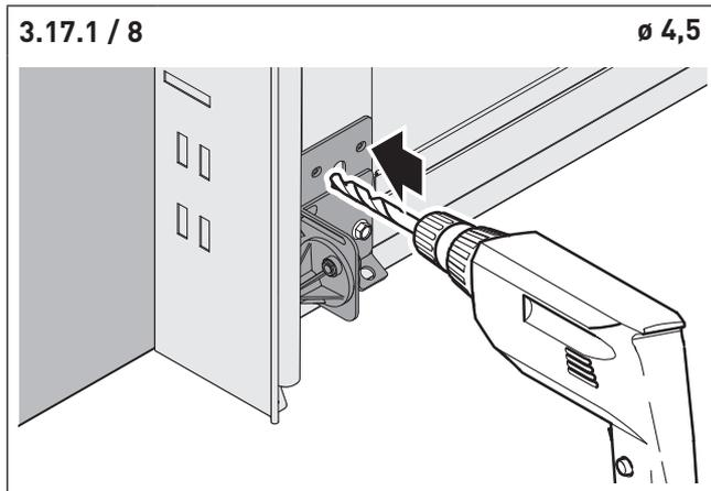
⇒ Bohren Sie gegebenenfalls die fehlenden Löcher für die Verschraubung.
