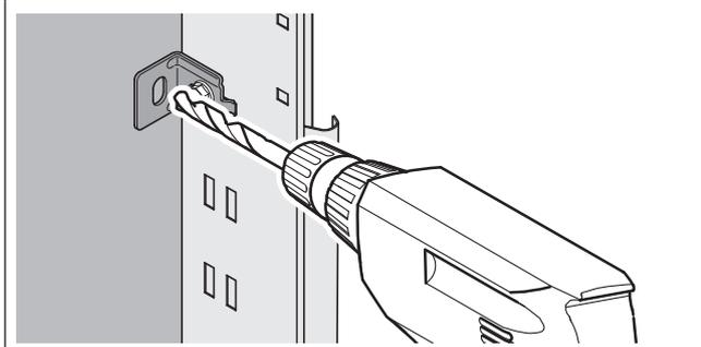
⇒ Bohren Sie neben der Zarge mind. 60 mm tief durch den Montagewinkel in die Mauer.
