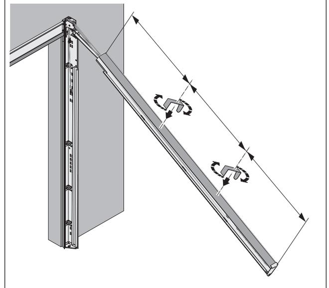
⇒ Sichern Sie die Abdeckung mit den Federkanalbügeln.
