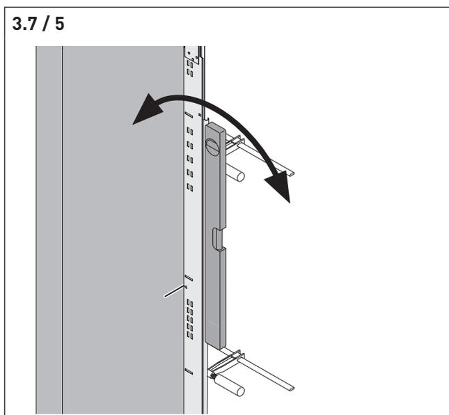
⇒ Prüfen Sie, ob die rechte und linke Zarge senkrecht zur Mauer ausgerichtet sind. Wenn die Zarge nicht senkrecht steht, muss diese unterfüllt werden.
