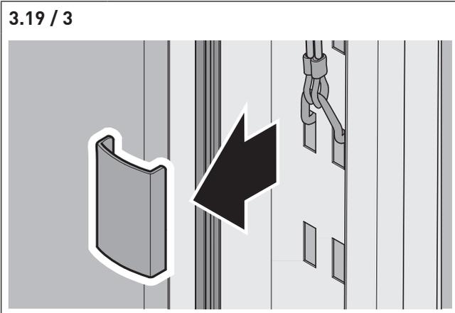
⇒ Entfernen Sie die Abdeckung des Seilbügels.
