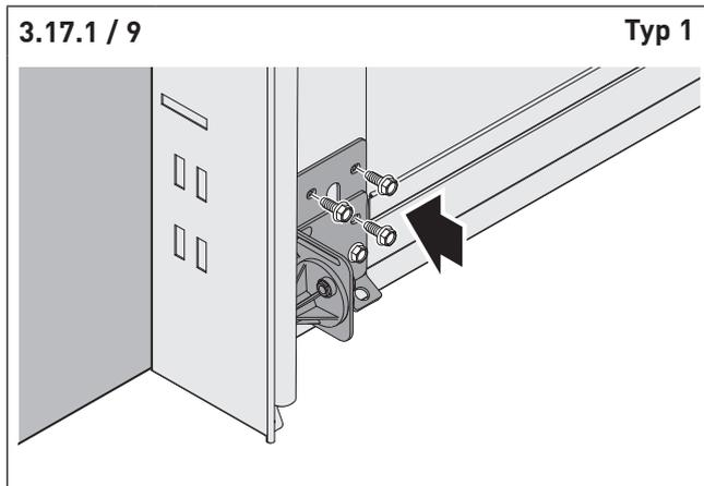
⇒ Verschrauben Sie die restlichen Schrauben der Bodenkonsole mit der unteren Torsektion.
