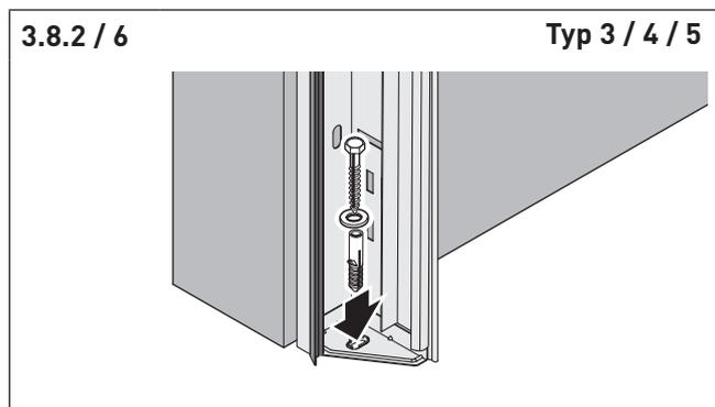
⇒ Verschrauben Sie die Zarge mit dem Boden.
