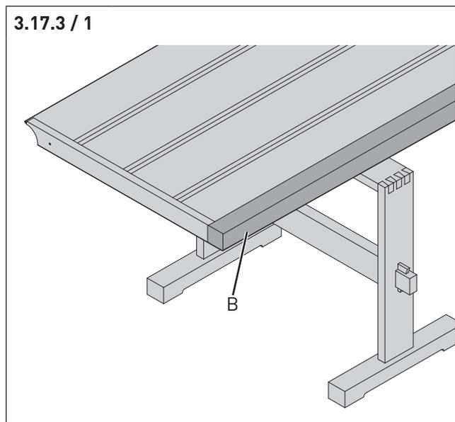
Bei Sondergrößen schließt die Topsektion mit einem Aluminiumprofil (B) ab.
