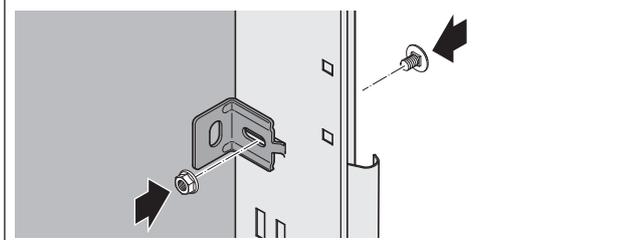
⇒ Verschrauben Sie den montierten Winkel seitlich mit je einer Schraube an der Zarge.
