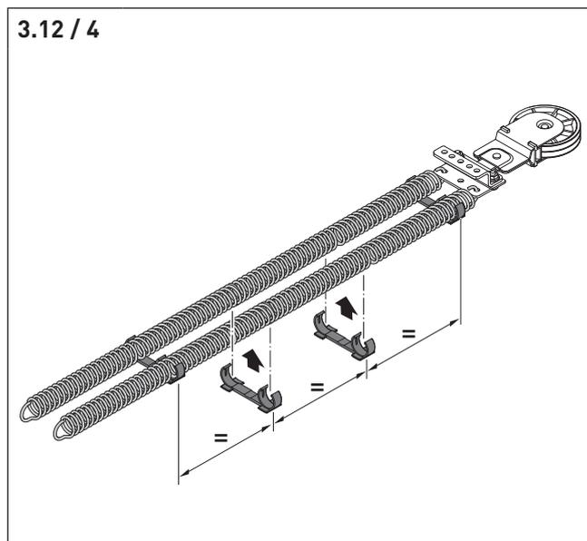
⇒ Stecken Sie die weiteren Kunststoff Gleitstücke von unten in gleichmäßigen Abständen auf die Federn.
