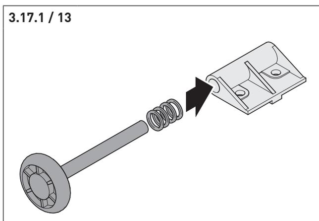
Beim Einsatz des 4-fach Federkanals muss das Tor mit Hilfe der Distanzringe (max. 8 Stück) mittig zwischen den Laufschienen ausgerichtet werden.
