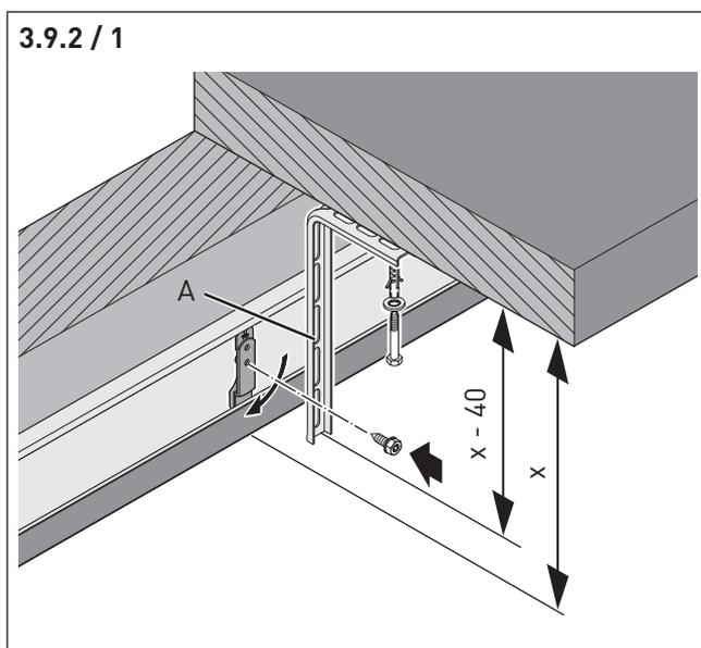
Bis zu einer Torbreite von 3 m reicht eine Verschraubung an der Sturzblende aus.
