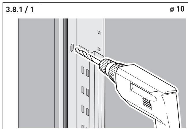
⇒ Bohren Sie durch die vorgestanzten Löcher in der Zarge mind. 60 mm tief in die Mauer.
