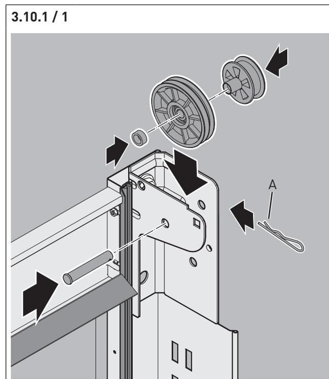
⇒ Setzen Sie die Seilrolle, den Distanzring und die Stützrolle zusammen mit dem Bolzen jeweils rechts und links in die Zargenkonsolen ein.
